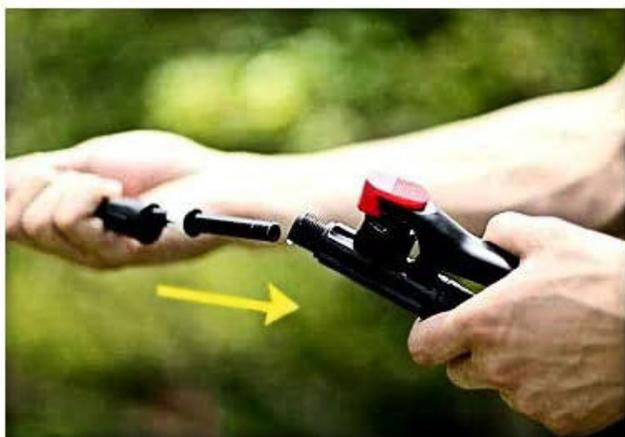
1 MONTAR LANZA DE PULVERIZACIÓN
